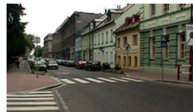
Obr. 20 a 21: Zúžení místní komunikace rozšířením chodníkové plochy v České Lípě (vlevo) či vložением středního dělicího ostrůvku ve Znojmo (vpravo)
