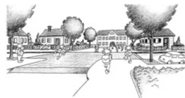
Obr. 9 a 10: Příklad využití zvýšené plochy v prostoru před základní školou. Toto řešení lze použít jak v přímém úseku komunikace, tak na křižovatkách.
